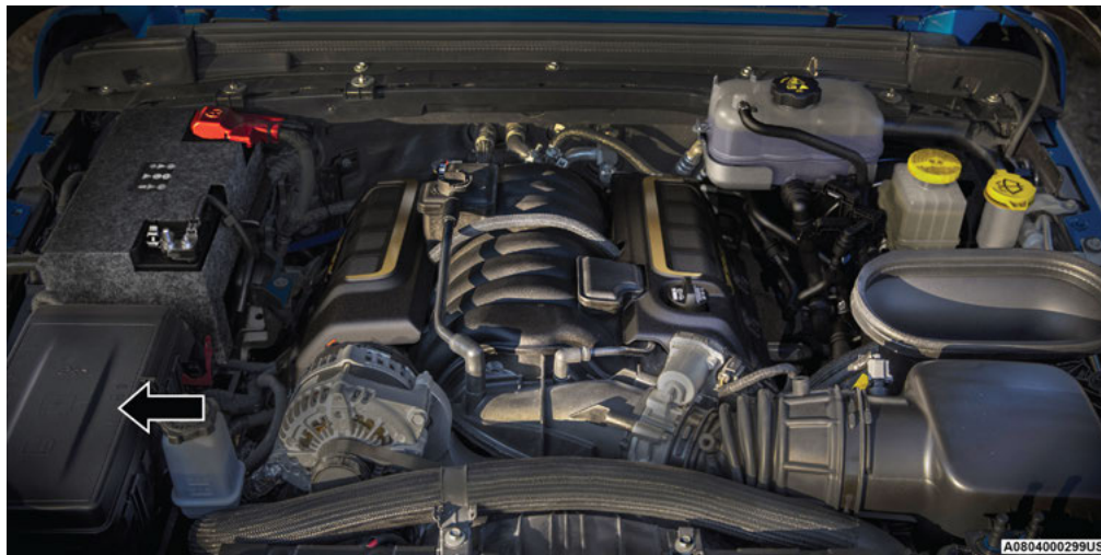
Centrum distribuce energie
