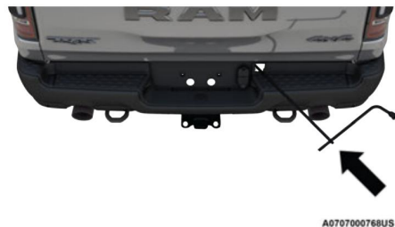
Vložení prodlužovacích trubek do přístupového otvoru
