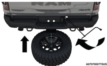
Opětovná instalace prázdné nebo náhradní pneumatiky
